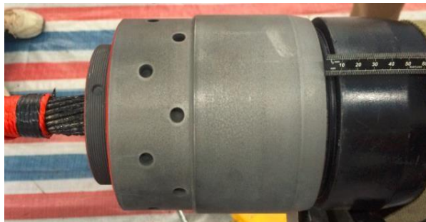
Рисунок 3-5 Принципиальная схема заделки брони. Прессование.
