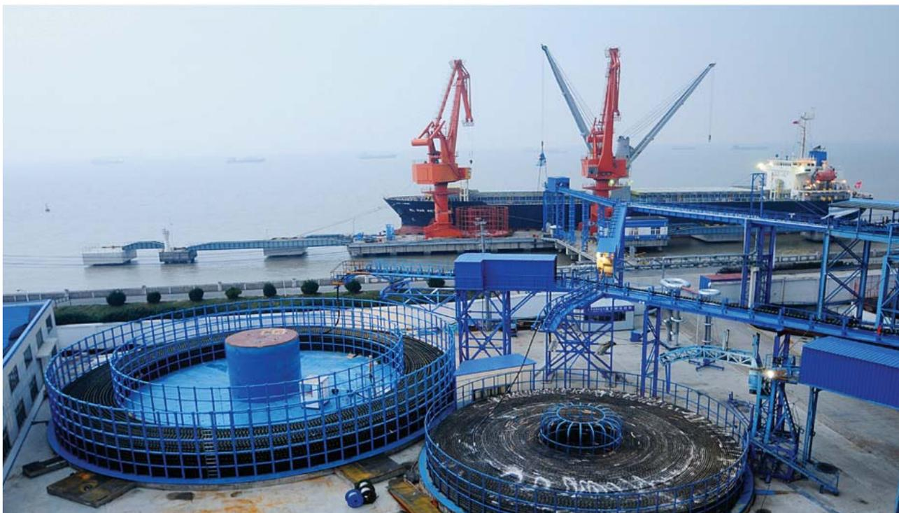
Подводные силовые кабели используются для соединения морских энергетических полей, приливных волн, ветряных мельниц и морских нефтегазовых платформ, а также островов. Напряжение для такого применения обычно менее 36 кВ переменного тока и обычно используют 3-жильные кабели XLPE.
