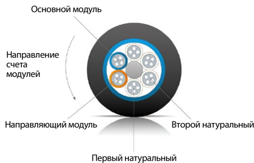
Рис. 7. Принцип кодировки оптических волокон в России
