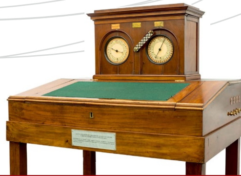
Электромагнитный стрелочный аппарат Б. С. Якоби со штепсельным передатчиком. 1843 год. Применялся на линии связи между зданием Главного управления путей сообщения и кабинетом Николая I в Александровском дворце в Царском селе
