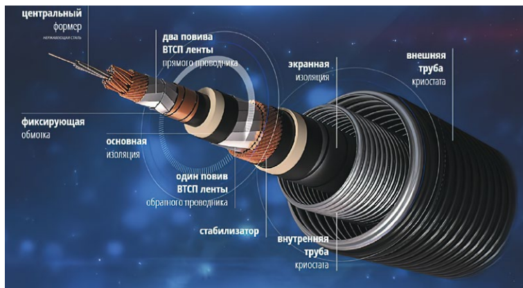
Рис. 9. Структура ВТСП-кабеля постоянного тока
