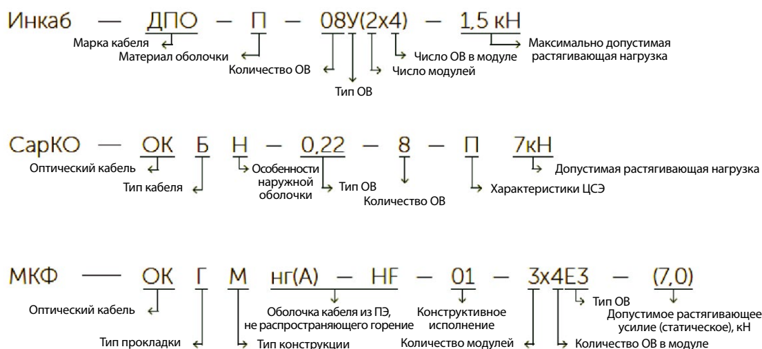
Рис. 1. Примеры структуры маркировки ОК различных заводов
