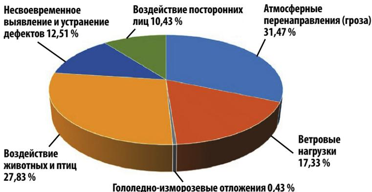
Рис. 1. Основные причины аварийных отключений ЛЭП напряжением 110 кВ в Калужской энергосистеме за 2017–2019 гг.
