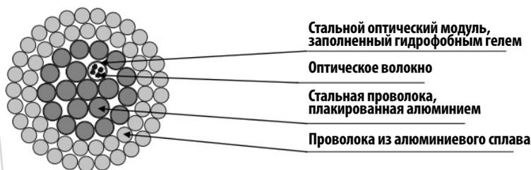
Рис. 4. Эскиз кабеля ОКФП с оптическим модулем в первом повиве
