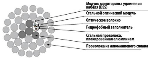
Рис. 8. Эскиз экспериментального ОКФП
