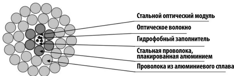
Рис. 3. Эскиз кабеля ОКФП с оптическим модулем в центре
