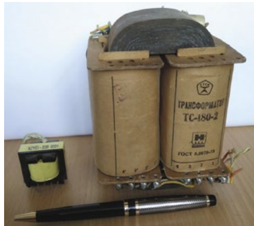
Рис. 2. Основные трансформаторы инверторного блока питания (слева) и блока питания предыдущего поколения (справа)
