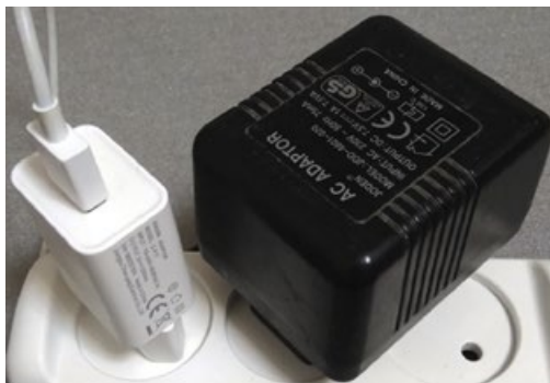
Рис. 1. Зарядное устройство сотового телефона (слева) и адаптер AC/DC (справа)
