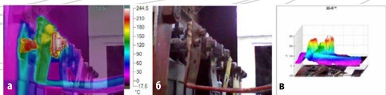
Рис. 1. Данные по измерениям температуры (перегрев 245 °С) на болтовом контактом соединении на левой шпильке (фаза С) в трансформаторе № 2: а — термограмма, б — фотография узла, в — графическое изображение
