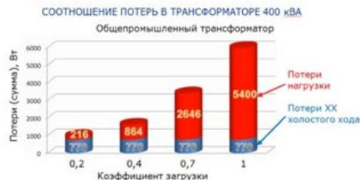
Рис. 4. Соотношение потерь в трансформаторе
