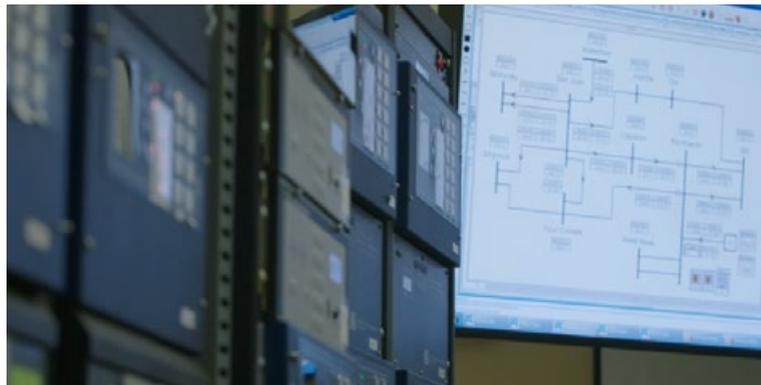
Испытания УЗВП SEL-T400L на RTDS
