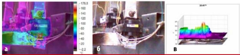
Рис. 2. Данные по измерениям температуры (перегрев 180 °С) на болтовом контактом соединении и на переходе первичной цепи: а — термограмма, б — фотография узла, в — графическое изображение
