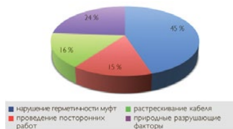
Рис. 2. Типичные дефекты кабельных линий
