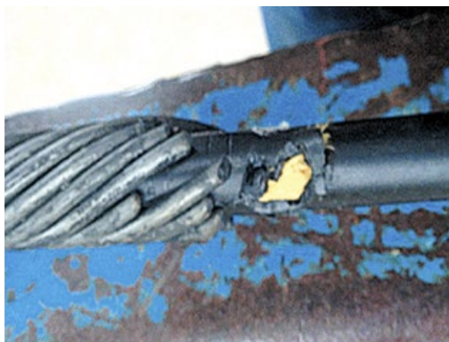
Рис. 2. Электротермическая деградация оболочки
