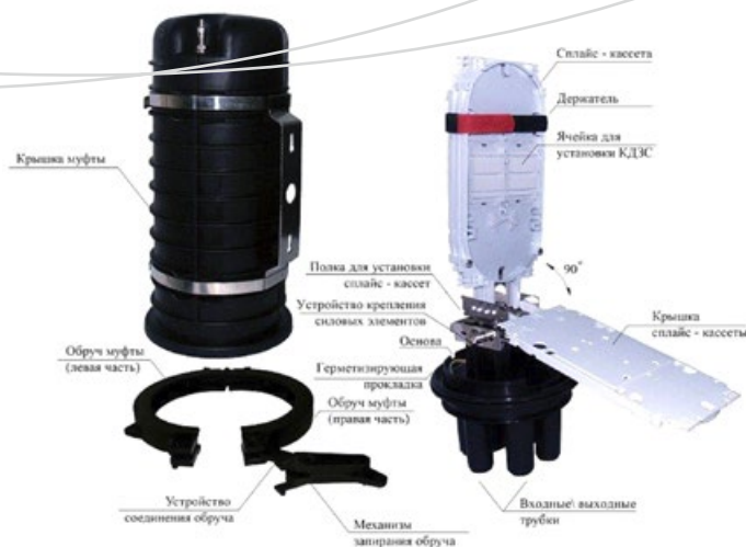
Рис. 7. Муфта для монтирования на сооружениях и столбах
