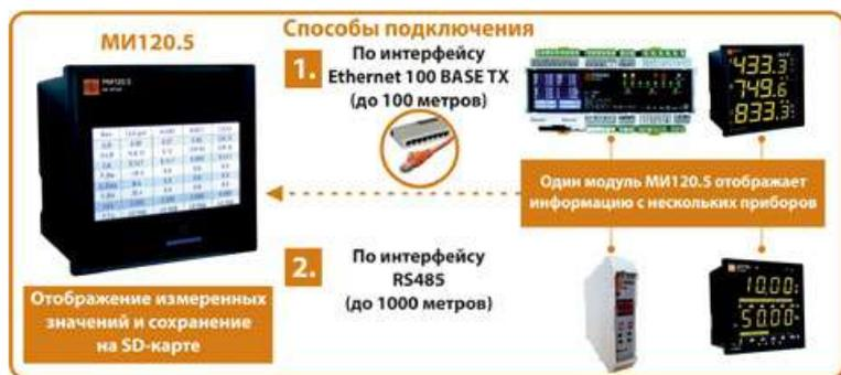
Рис. 1. Модуль индикации МИ120.5
