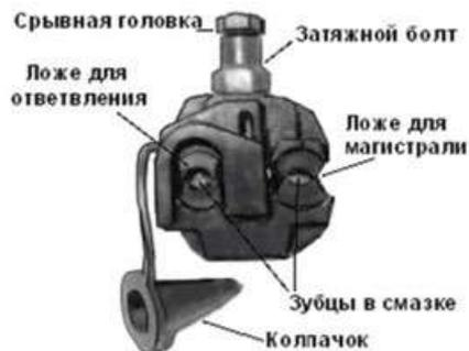
Рис. 1. Конструкция зажима для СИП
