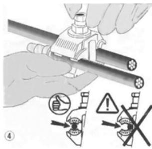
**Рис. 8. Контроль совпадения проводов с осью симметрии своей контактной группы**
