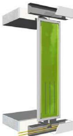
Рис. 4. Фасадный модуль биореактора с микроводорослями. Технология SolarLeaf
