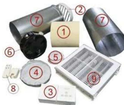
Рис. 1. Составляющие вентилятора-рекуператора: 1 — керамический рекуператор; 2 — уличная декоративная решетка; 3 — блок управления; 4 — фильтр; 5 — детектор дыма; 6 — осевой вентилятор; 7 — телескопический корпус устройства; 8 — пульт управления; 9 — внутренняя декоративная решетка с жалюзи
