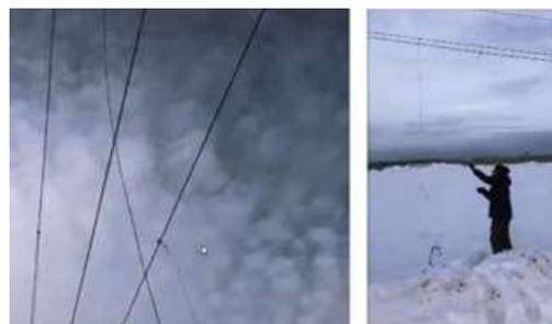
Рис. 12. Имитация тряски ОКГТ с помощью подвешенных канатов
