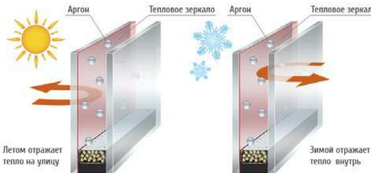
Рис. 7. Технология «тепловое зеркало»
