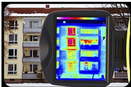
Рис. 1. Характерный случай некачественного регулирования системы отопления
