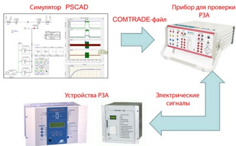
Рис. 2. Упрощенная функциональная схема стенда для изучения устройств РЗА
