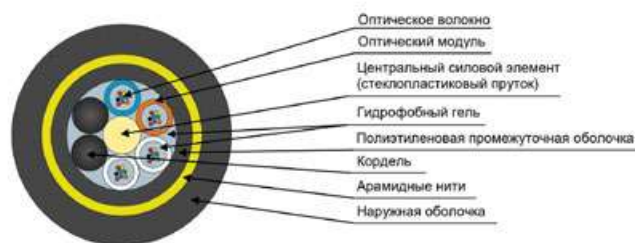
Рис. 1. Поперечное сечение ОКСН
