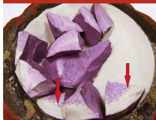
Рис. 3. Образец фарфора верхней части изолятора после испытания методом фуксиновой пробы под давлением
