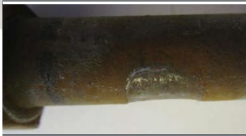
Рис. 5. Истирание болта зажима AGS
