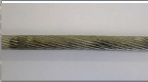
Рис. 2. Участок провода, находившийся под эластомерной вставкой
