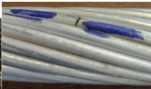
Рис. 1. Сломанная проволока внешнего повива провода
