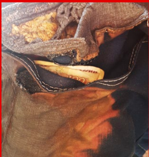
Фрагмент термостойкой куртки после мощного воздействия электрической дуги в ходе испытаний
