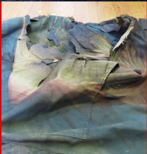
Фрагмент термостойких брюк пострадавшего со следами воздействия электрической дуги в области бедра
