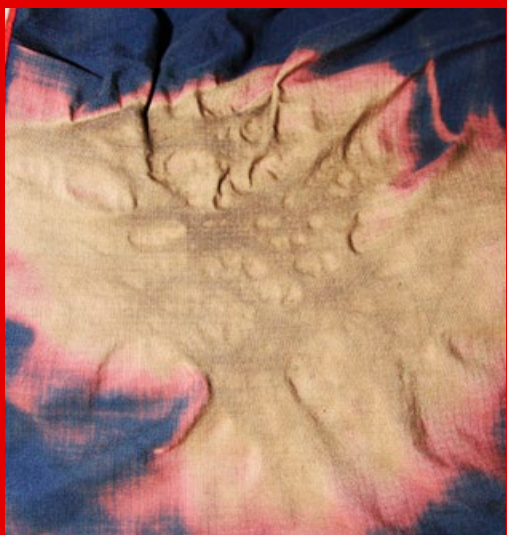
Фрагмент термостойкой куртки пострадавшего со следами воздействия электрической дуги в области спины
