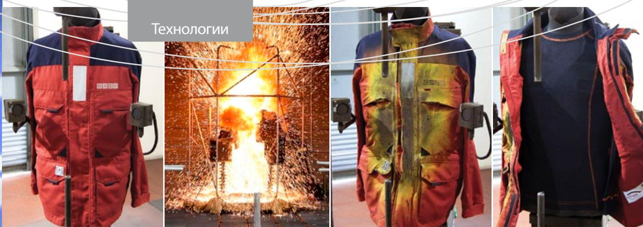
Рис. 3. Этапы испытания термостойкой куртки электрической дугой (архив «Энергоконtrakта»)
