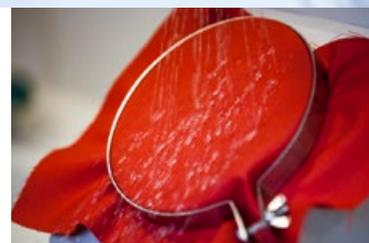
Рис. 5. Процесс дождевания для оценки водоотталкивающих свойств
