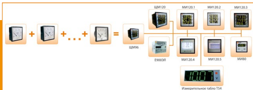
Рис. 1. Пример замены стрелочных приборов многофункциональными
