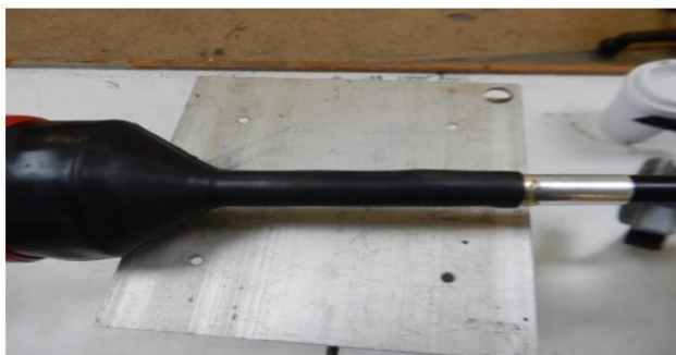
Рисунок 3-4 Принципиальная схема термоусадки
