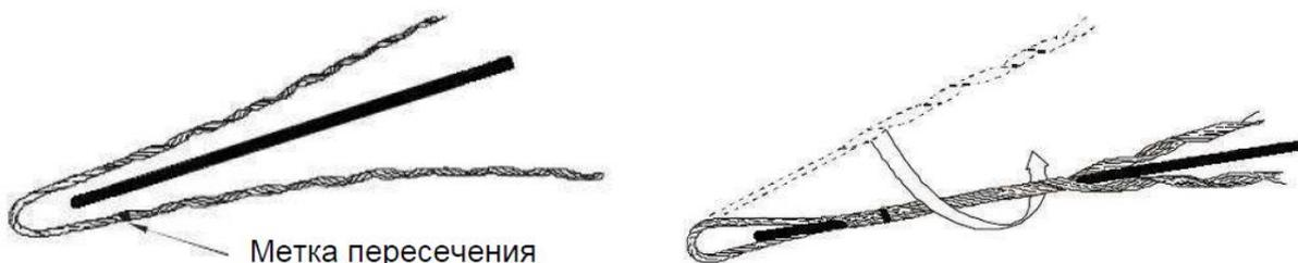
2. Продолжайте навивать пряди на провод, так, чтобы в процессе навивки каждая последующая прядь прижималась к предыдущей. Не навивайте два последних витка.
